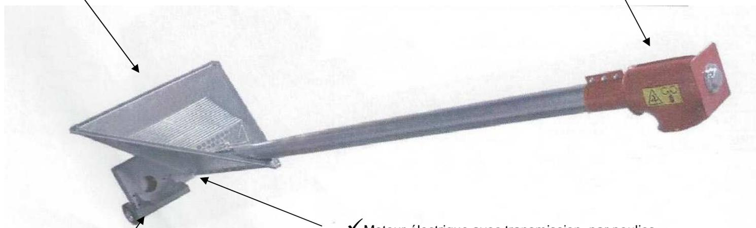
✓ Moteur électrique avec transmission par poulies et courroies.
