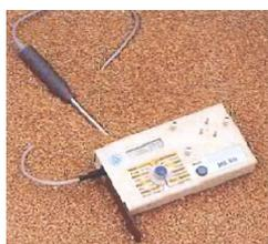
HE50 est adapté pour la connexion d'une sonde de température (diverses longueurs et différents types de sonde de température disponibles)
